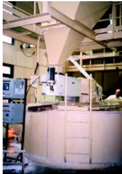
Figura 1-12. Dosificador de tipo volumétrico (1)
