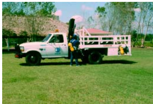
Figura 6-38. Vehículo equipado para emergencias originadas por el cloro (2)
