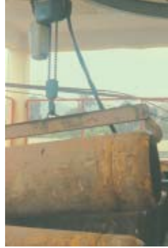
Figura 6-9. Sistema de grúa para cilindros grandes (2)
