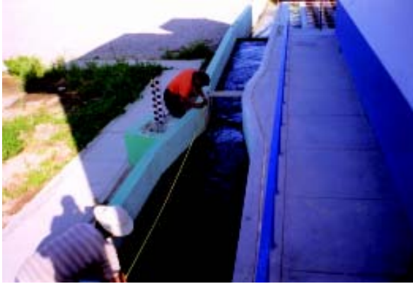
Figura 2-14. No llega a formarse el resalto (4)
