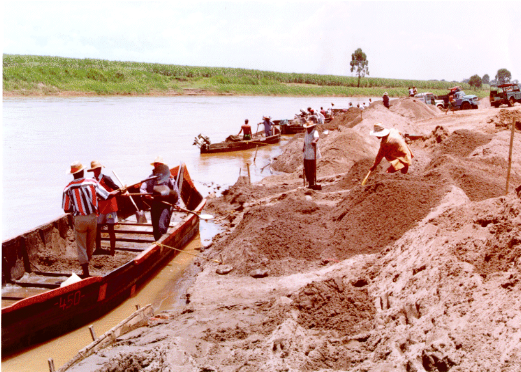
3.4.2 Figura 6.1 Explotación artesanal de grava y arena. Materiales básicos para el tratamiento FiME. Río Cauca, corregimiento El Hormiguero, Cali, Colombia, 1997
