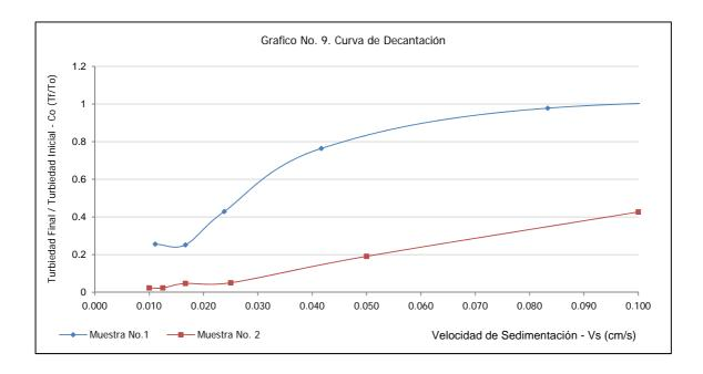
Del estudio de las curvas de decantación, se determinó que con una tasa promedio de  $30~\text{m}^3/\text{m}^2.\text{d}$  se podía obtener un efluente con 1.25 NTU para la muestra No.1 y de 2.03 NTU con la muestra No.2 (Ver cuadros No. 12,13), para efectos de diseño se debe dar una holgura del 30%, por lo tanto se diseño se realiza con una tasa de decantación de  $21~\text{m}^3/\text{m}^2.\text{d}$
